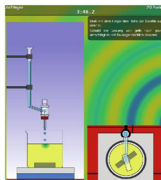
Abb.1: Titrationstrainer : Titration einer vorgelegten sauren Lösung mit einer alkalischen Maßlösung, Indikator: BTB
